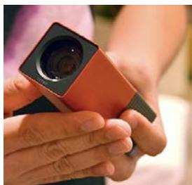
图 1-7 Lytro 公司的光场照相机<sup>[10]</sup>
