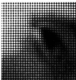
图 11-13 微透镜光场照相机采集到的原始图片<sup>[5]</sup>
