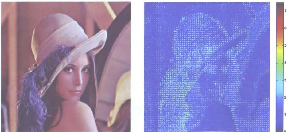
图5-7 8×8块状DCT变换
