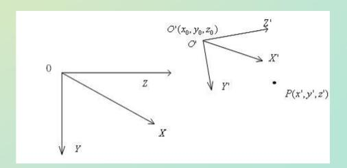
引申到三维空间,第一个阶段:我们依旧从旋转和平移两个步骤 来推算从世界坐标系到相机坐标系的坐标变换,
